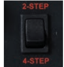
2 такта/4 такта при МИГ/МАГ заваряване
