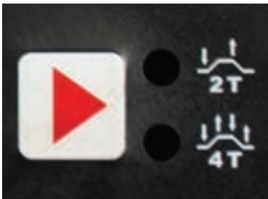
2 такта/4 такта при МИГ/МАГ заваряване
