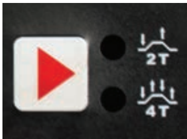
2 такта/4 такта при МИГ/МАГ заваряване
