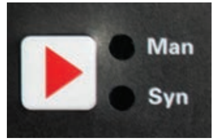
Ръчен и синергичен режим на МИГ/МАГ
